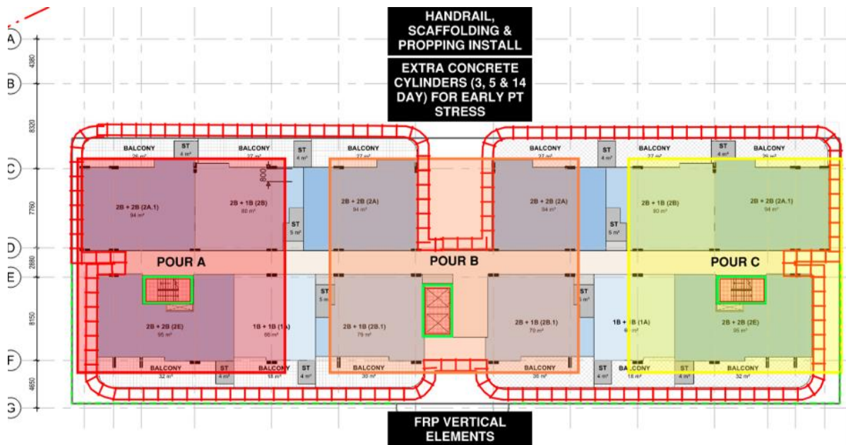
Figure 10: Vertical Element Pour Sequence
