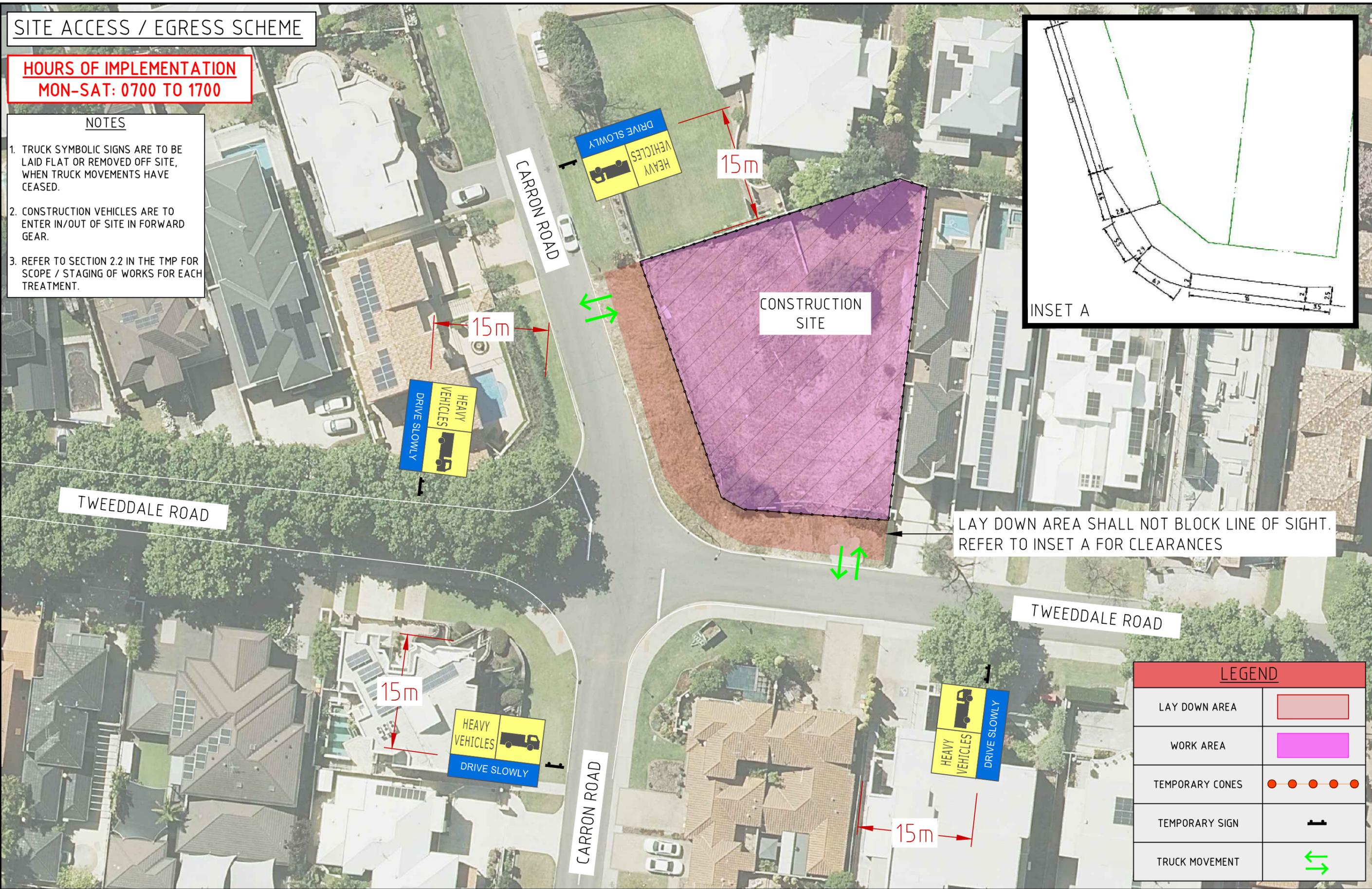
LAY DOWN AREA SHALL NOT BLOCK LINE OF SIGHT. REFER TO INSET A FOR CLEARANCES
